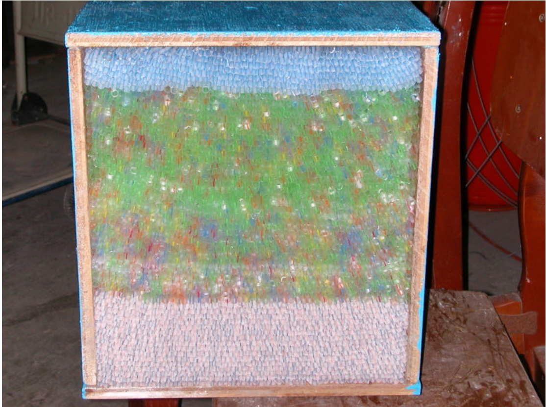
風洞入口處用吸管製成穩流版
