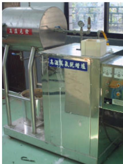
圖（4.13）陶瓷殼模蒸氣脫蠟爐
