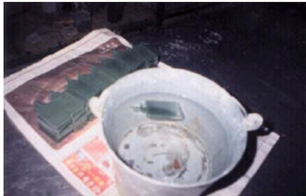
圖 (4.5) 蠟模水冷定型作業
