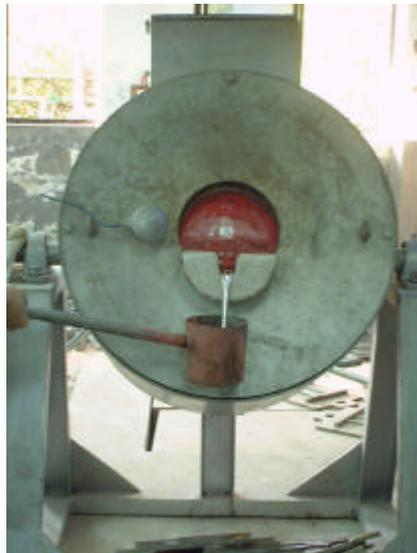
圖（4.15）高週波感應電爐熔解合金鋼作業
