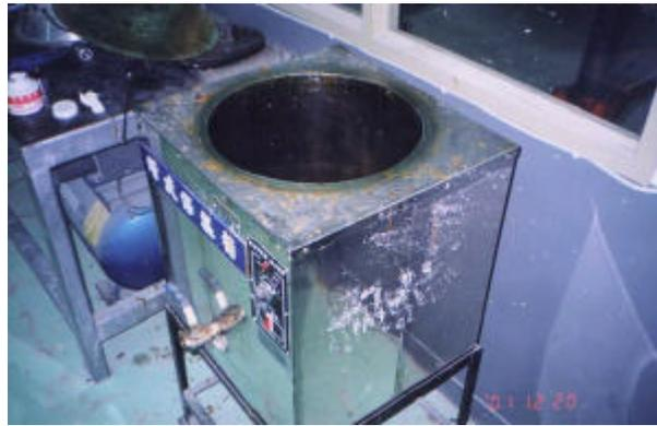
圖（4.1）熔解蠟液作業
