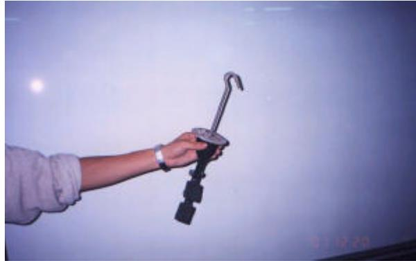
圖(4.7)蠟樹頭(內包附螺桿金屬錐與把手的螺桿栓合)
