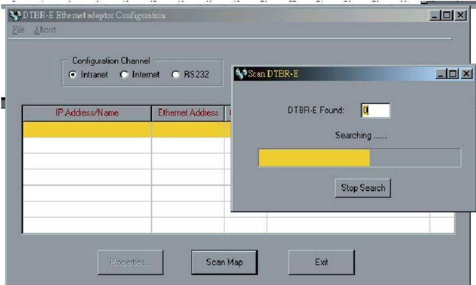
4. 出現尋找的視窗,如找到 PLC 則會顯示出 1,沒找到則為 0,沒有找到對應的 PLC 可能的情形有,網路線是否為正常,有分為跳線和未跳線,我們這組用的網路線為未跳線,連接到(Hub)集線器,在 Hub 輸入端連接到學校的區域網路,輸出端則連到 PLC 的網路介面(UBTR-E)和電腦的網路卡上.PLC 的 IP 位址輸入由 RS-232 輸入,方式為上前 3 頁的 RS-232 連結方式,在設定時,選向新增的地方選擇設定用網入連結的方式,如圖 10
