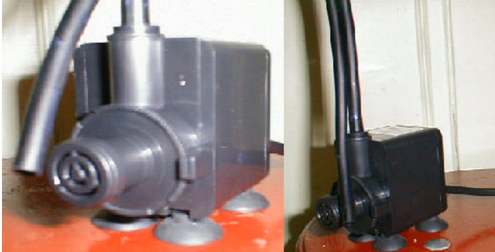
圖(2-7) 水冷器抽水馬達的外觀
