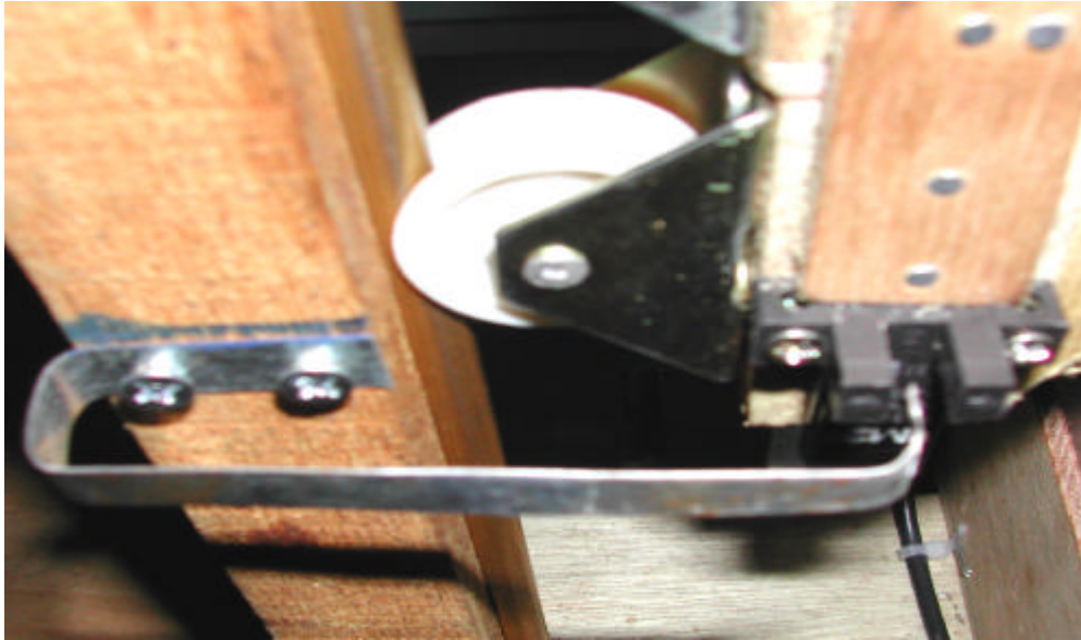
圖三十四 利用光電感測器來達到計數
