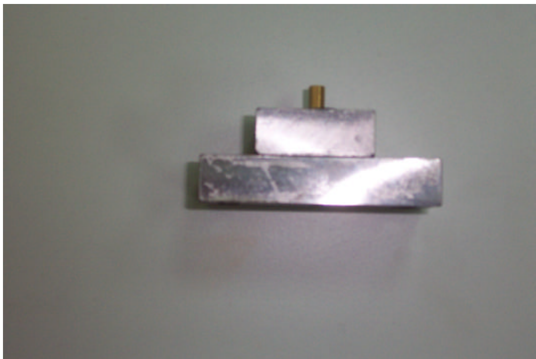
鋼塊與銅柱組合前視圖（銅柱為 10mm）
