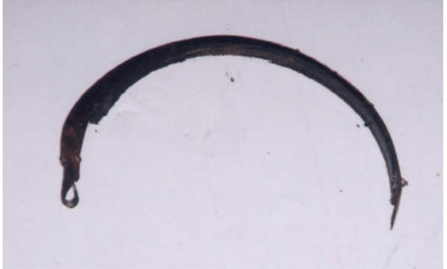
圖 3-8 斷裂之煞車皮
