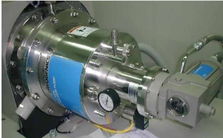
圖 3.8 冷凍泵的實際圖
